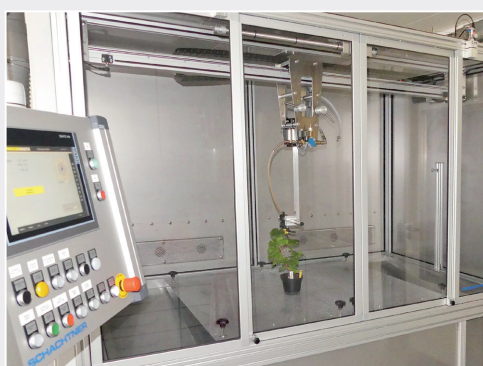
Laborapplikationsanlage für Pflanzenschutzmittel Laboratory application device for plant protection products
