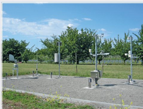
Wetterstation und Sporenfalle auf dem Versuchsfeld des Instituts Weather station and spore trap in the research orchard of the Institute
