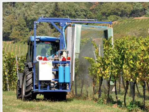
Parzellensprüngerät im Einsatz im Weinberg Plot sprayer for the experimental application in vineyards
