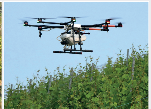
Versuch zur Pflanzenschutzmittelapplikation mit Drohnen Drone borne aerial application of fungicides
