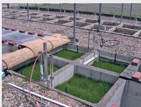
Lysimeteranlage zur Messung des Abbaus von Pflanzenschutzmitteln Lysimeter station for measuring the degradation of pesticides
